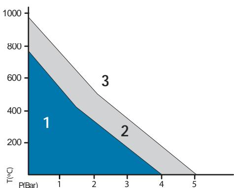
El diagrama P-T ayuda al usuario o ingenier@ que conoce las condiciones de servicio ( Presión y temperatura ) a elegir el material para juntas apropiado. El diagrama P-T no garantiza el funcionamiento de un material para una aplicación.
